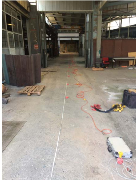
Fig. 7 – Prova sismica Masw
